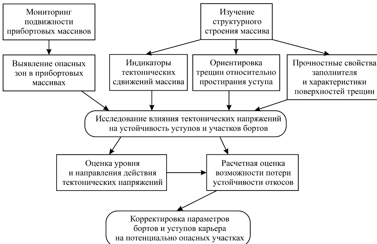
Рис. 1. Алгоритм обоснования устойчивости бортов и уступов для действующих карьеров
