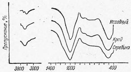
полоса поглощения при меньших частотах ( $3400 \text{ см}^{-1}$ ) характерна для триоктаэдрического заселения катионами типа  $R^{++}$  ( $Mg^{++}$ ,  $Fe^{++}$ ), полоса при больших частотах ( $3590 \text{ см}^{-1}$ ) чувствительна к ориентировке кристалла и характеризует заселение либо неоднородными по валентности катионами, либо дефектное заселение. В данном образце, по-видимому, имеется в большем количестве неоднородное заселение октаэдрических структурных позиций.
