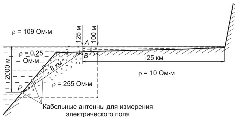
**Рис. 7. Схематический геoeлектрический разрез района измерений.**
