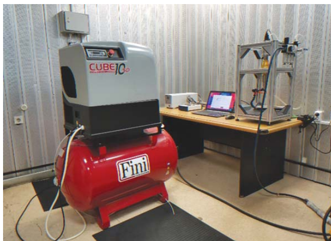
Рис. 3. Пьезоэлектрическая установка для проведения испытаний на СвМУ при одноосном нагружении
