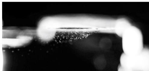
Рис. 2. Микрокапли, вылетающие снизу экспериментальной установки через центральное отверстие.
