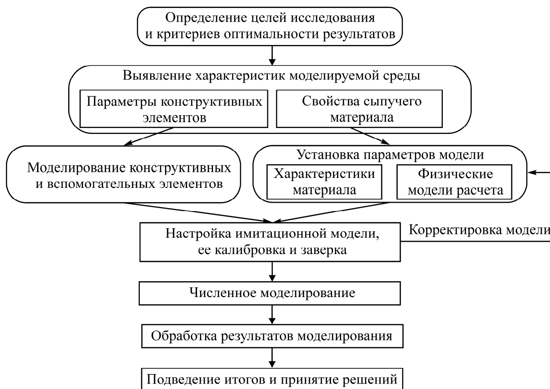
Рис. 1. Блок-схема алгоритма моделирования выпуска руды
