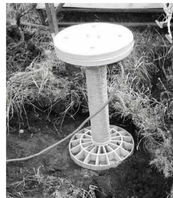
Рис. 2. Геоакустический пьезокерамический источник в рабочем положении
