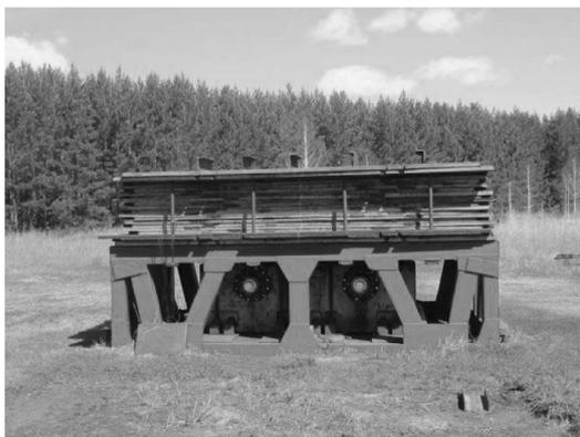
Рис. 1. Низкочастотный сейсмический вибратор ЦВ-40
