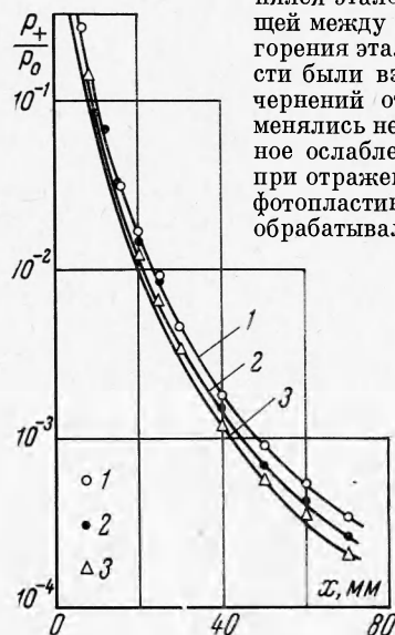
Фиг. 2. Распределение относительных полных напоров вдоль оси струи: 1 — T_0 = 7 \cdot 10^3 °K, 2 — T_0 = 9.1 \cdot 10^3 °K, 3 — T_0 = 11.2 \cdot 10^3 °K
