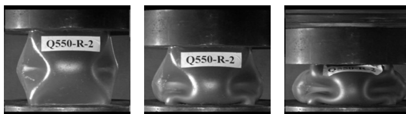
Рис. 7. Продольный изгиб односекционного энергопоглощающего элемента
