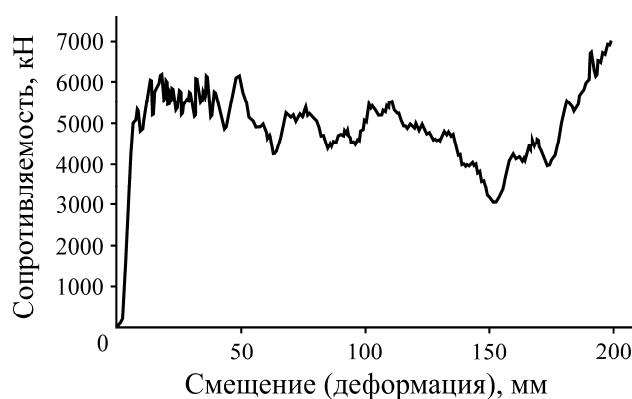
Рис. 13. Соотношение сопротивляемости смещению и деформации при ударном воздействии
