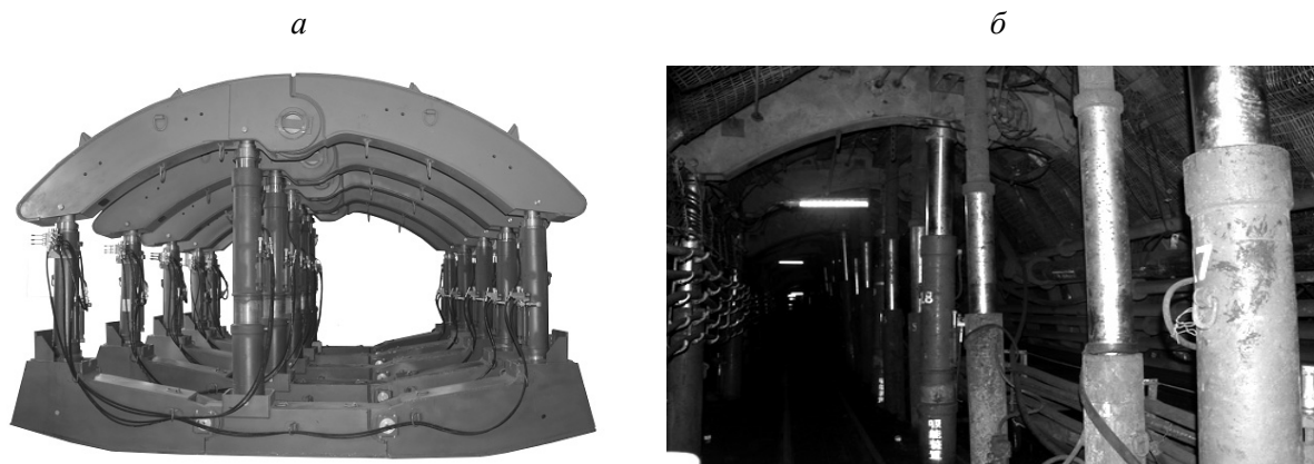
Рис. 14. Физическое исполнение крепей арочного типа (а) и их применение в подземной выработке (б)
