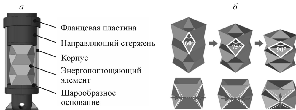
Рис. 5. Конструкция энергопоглощающего устройства (а) и характер деформации энергопоглощающего элемента (б)
