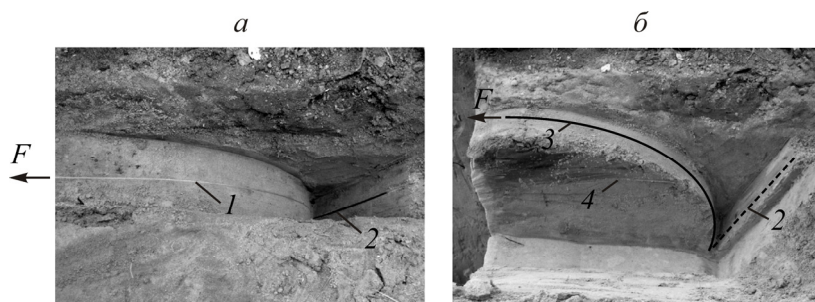
Рис. 8. Вид на трос (а) и его «грунтовую опору» (б) после вскрытия основания по завершению эксперимента ( \beta = 135^\circ ): 1 — трос после натяжения; 2 — след установочной скважины анкера; 3 — след троса; 4 — грунтовая опора
