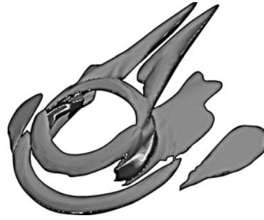
Рис. 2. Вихревая структура течения вокруг шероховатости ( Q -критерий) на затупленном конусе при r = 9 мм, \theta = 60^\circ .
