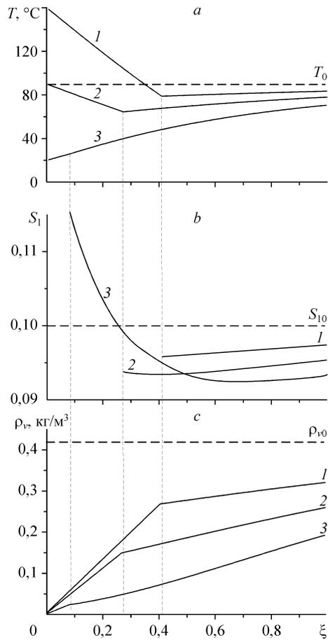
Рис. 4. Профили температуры (а), объемного влагосодержания (b) и плотности пара (с) при сушке горячей среды ( $T_0 = 90^\circ\text{C}$ ,  $S_{10} = 0,1$ ) сухим воздухом ( $\rho_{ve} = 0$ ). Линии 1, 2 и 3 соответствуют  $T_e = 160, 90$  и  $20^\circ\text{C}$ .
