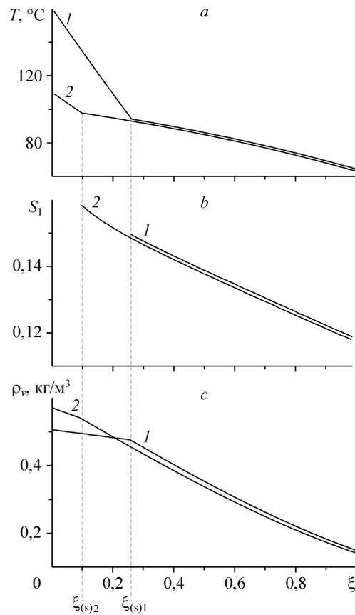
Рис. 3. Распределения температуры (*a*), влагосодержания (*b*) и плотности пара (*c*) в пористой среде при сушке перегретым паром. Линии 1 и 2 соответствуют  $T_e = 160$  и  $110$  °С,  $T_0 = 20$  °С,  $S_{I0} = 0,1$ .
