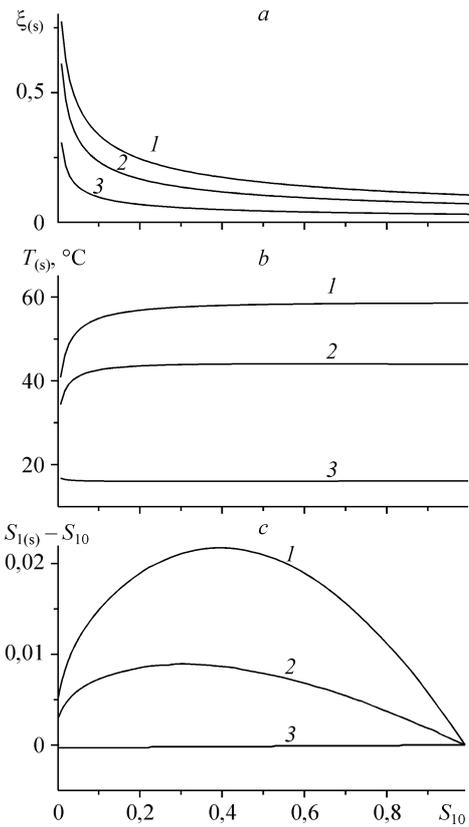
Рис. 5. Зависимости автомодельной координаты  $\xi(s)$  (а), температуры на границе влажной зоны  $T(s)$  (b) и разности объемных влагосодержаний  $S_{1(s)} - S_{10}$  (с) от исходного влагосодержания при сушке сухим воздухом. Линии 1, 2 и 3 соответствуют  $T_e = 140, 80$  и  $20^\circ\text{C}$ .
