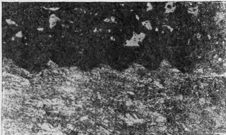
Рис. 5. Микроструктура соединения титана со свинцом.  $\times 150$
