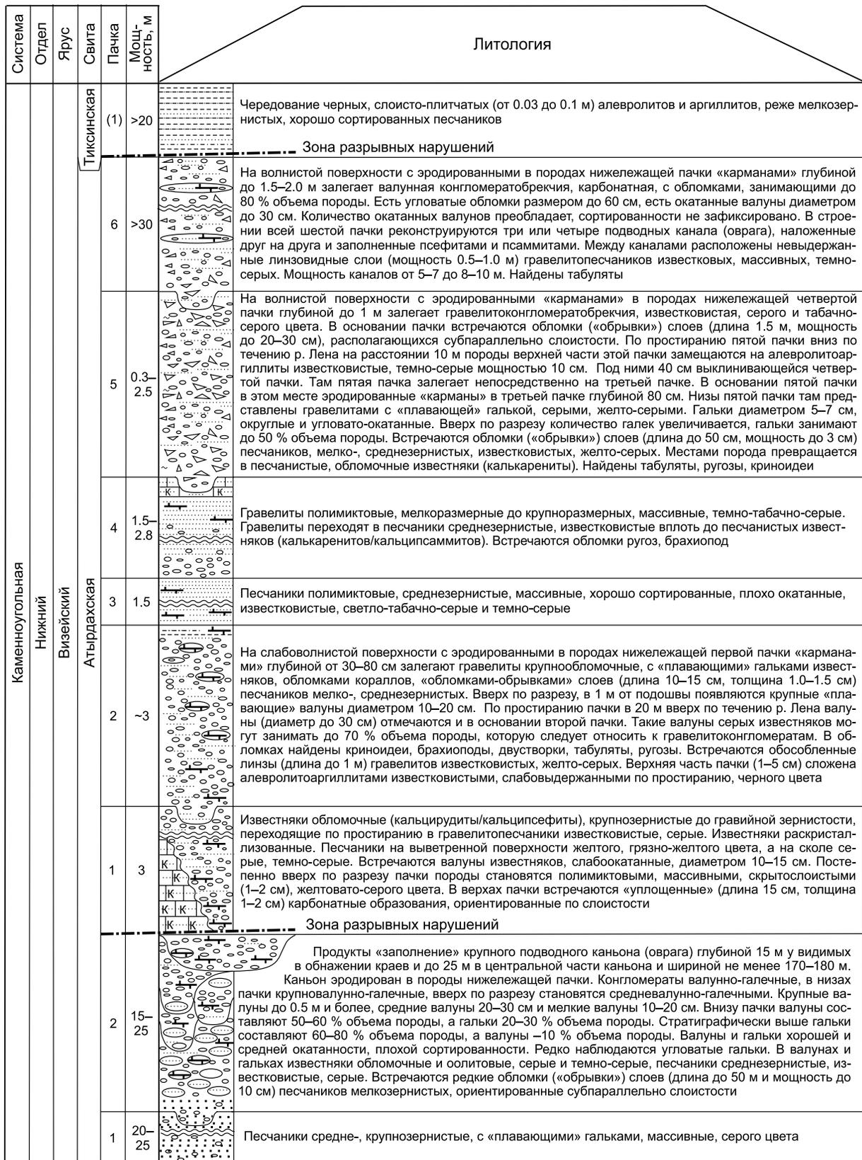
Рис. 8. Литологическая колонка составной терминальной части разреза крестяхских конгломератов (С-1878 внизу и С-1883 вверху — правый берег Лены до начала Быковской протоки), С-1878 — 72° 23' 15" с.ш., 126° 44' 05" в.д.; С-1883 — 72° 23' 05" с.ш., 126° 44' 25" в.д.).
