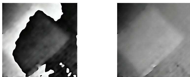
Рис. 5. Пример необработанных фазовых разрывов (слева) и результата восстановления разрывов фаз (справа)
