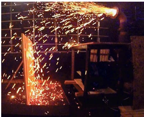
Рис. 5. Модель ограждения комбинированного типа во время эксперимента
