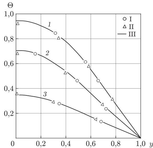
Рис. 4. Распределения температуры, полученные с использованием метода Л. В. Канторовича (I) и по формуле (3.1) при  $n = 3$  (II), а также точное решение [11] (III) при различных значениях  $x$ :
