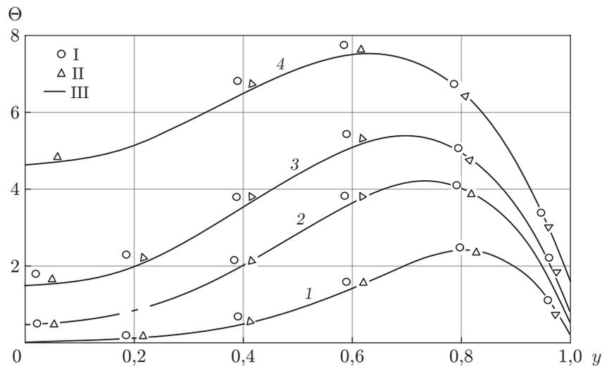
Рис. 3. Распределения температуры, полученные по формулам (2.15) (I), (2.19) (II) и при численном решении задачи (III) при  $A = 15$ ,  $D = 200$  и различных значениях  $x$ :
