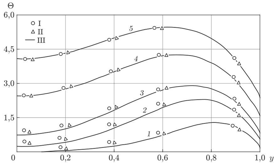
Рис. 2. Распределения температуры, полученные по формулам (2.15) (I), (2.19) (II) и при численном решении задачи (III) при  $A = 15$ ,  $D = 100$  и различных значениях  $x$ :
