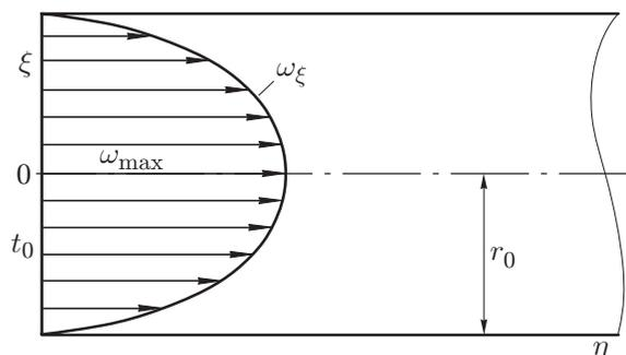
Рис. 1. Схема установившегося ламинарного течения жидкости в круглой трубе
