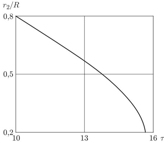
Рис. 3. Закон движения границы области вязкопластического течения для случая уменьшающейся скорости движения жесткой поверхности
