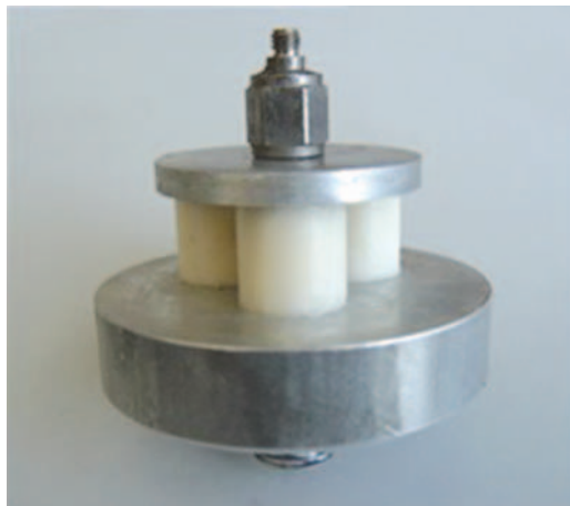
Рис. 1. Цилиндрические образцы, приклеенные к вибростолу
