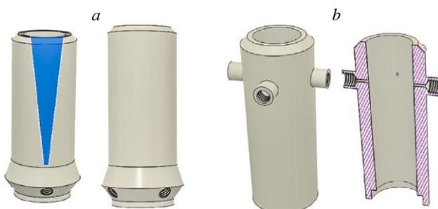
Рис. 2. Насадки с реализациями аксиального (*a*) и поперечного воздействия (*b*).
