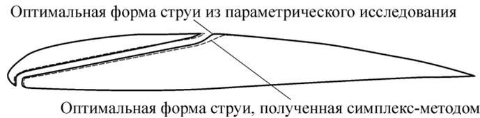
Рис. 16. Сравнение оптимальной формы пассивных струй, полученных с помощью параметрического исследования и с помощью симплекс-алгоритма.
