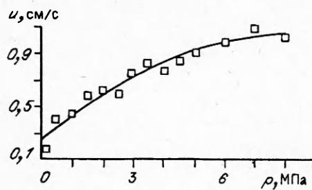
Зависимость скорости горения стехиометрической смеси ультрадисперсного Al с гелеобразной водой от давления.
