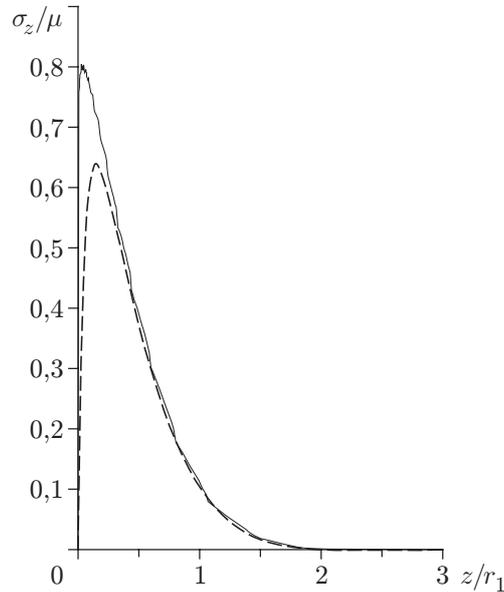
Рис. 2. Распределение нормальных напряжений  $\sigma_z$  по боковой поверхности стержня, построенное методом конечных элементов (сплошная линия) и методом однородных решений (штриховая линия) при  $\nu = 0,25$ ,  $L/r_1 = 12$ ,  $\psi r_1 = 0,3$ ,  $r_1 = 1$
