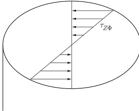
Рис. 1. Распределение касательных напряжений для естественного граничного условия на торце цилиндра
