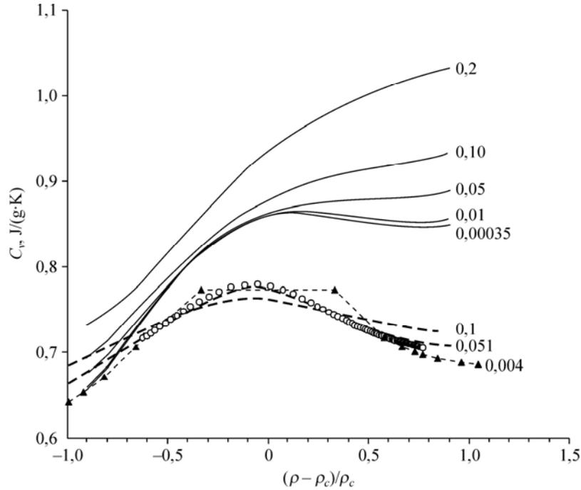
Рис. 3. Поведение регулярной части  $C_v$  (13) на изотермах. Кривые помечены значениями  $\tau = (T - T_c)/T_c$ : сплошные линии — расчет по константам УС (8)  $A_1, A_2, A_7, A_8$  из табл. 2 ( $\sigma = 0,34\%$ ); кружки — расчетная изотерма  $C_v$  при  $\tau = 0,05$  интерполяционного уравнения NIST [28], треугольники и штриховые линии — расчет по УС из работы [1].
