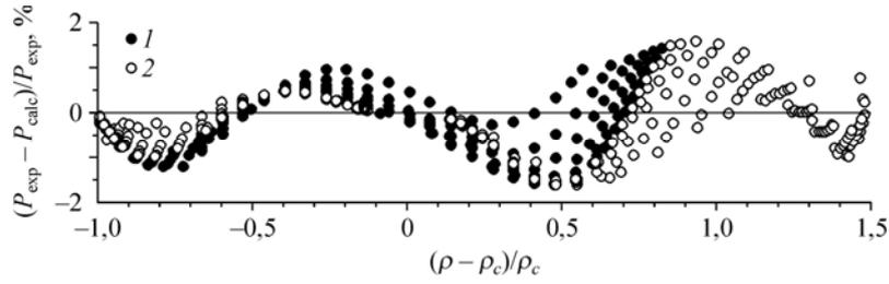
Рис. 1. Отклонения расчетного давления по регулярному УС (1) с учетом условий (3) от экспериментальных значений для SF<sub>6</sub>. Коэффициенты УС в табл. 1 (σ = 0,74 %).
