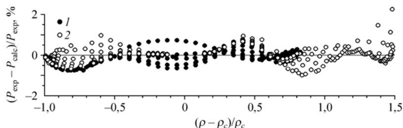
Рис. 2. Отклонения расчетного давления по комбинированному УС (8) от  $P$ - $\rho$ - $T$  данных для  $SF_6$ . Коэффициенты УС (8) взяты из табл. 2 ( $\sigma = 0,0128$  МПа).
