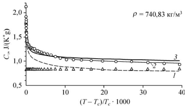
Рис. 4. Раздельный и полный расчет  $C_v$  на критической изохоре  $SF_6$  с использованием констант комбинированного УС (8) (табл. 2, метод МОФ).
