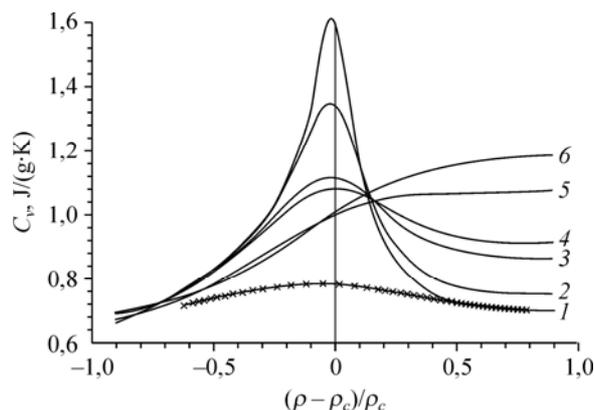
Рис. 5. Расчетное поведение  $C_v$  на изотермах  $T > T_c$ , константы табл. 2 ( $\sigma = 0,34\%$ ).
