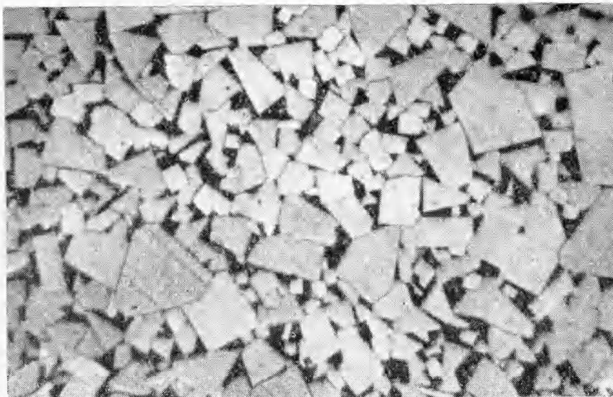
Рис. 1. Микроструктура исходного твердого сплава, \times 1600 .
