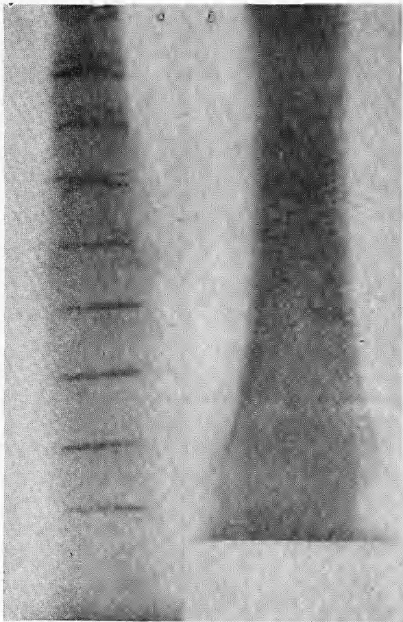
Рис. 5. Рентгеновские фотографии ударного сжатия ампулы в режиме с образованием маховской волны.
