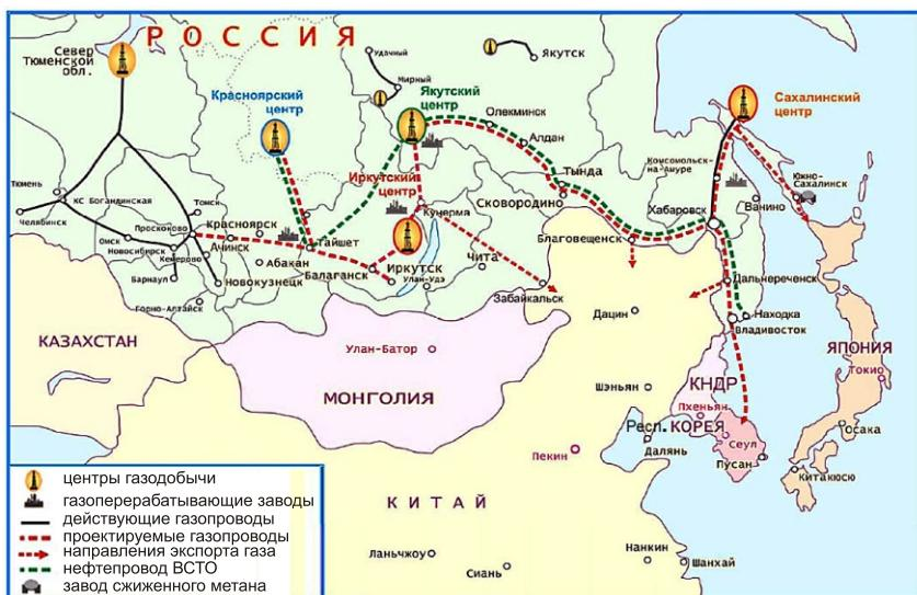
*Рис. 4. Схема возможных маршрутов прохождения газопроводов
