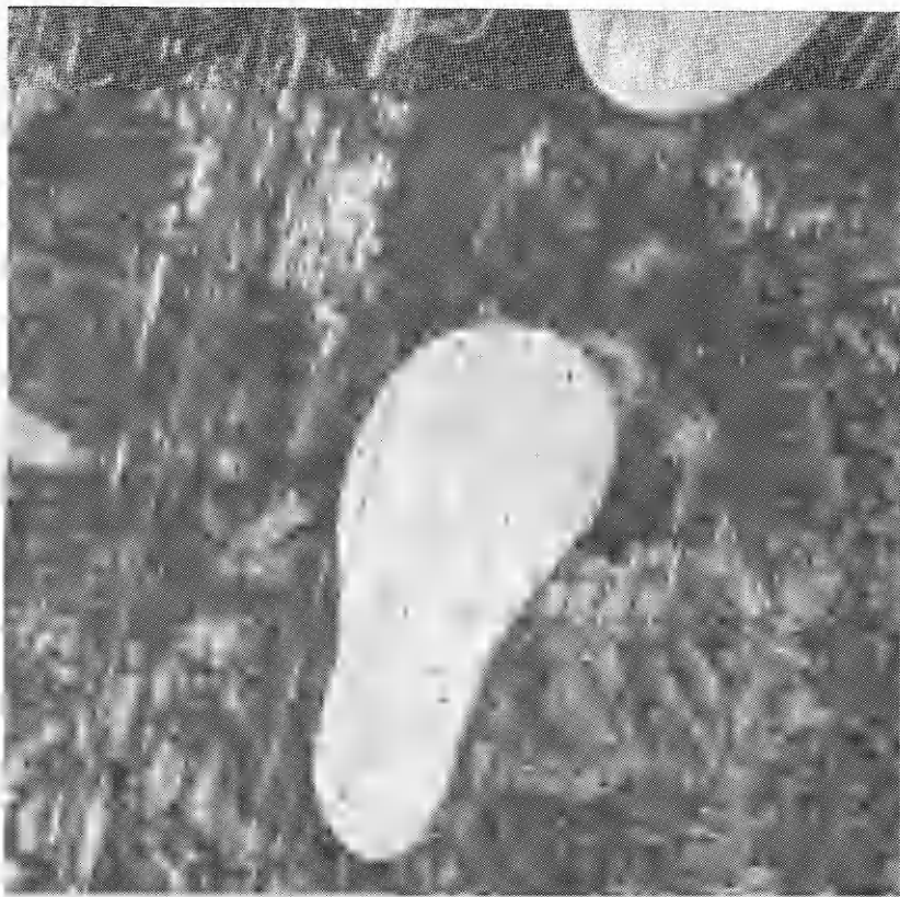
Рис. 5. Микроструктура при проникновении твердой частицы в сталь.
