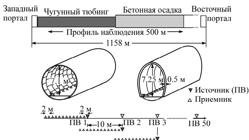
Рис. 1. Фланговая линейная система наблюдений: положение профиля наблюдения, источников и приемников вдоль стенки тоннеля, схема смещения пунктов возбуждения (ПВ) вдоль профиля
