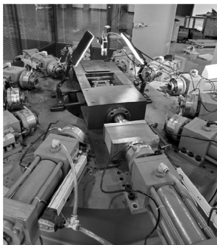
Рис. 1. Испытательная установка для определения уровня поглощения энергии ( a ) и ее схема ( б ): 1 — ударный гидроцилиндр; 2 — датчик давления; 3 — механизм крепления образца; 4 — датчик остаточной энергии; 5 — датчик смещения; 6 — образец угля
