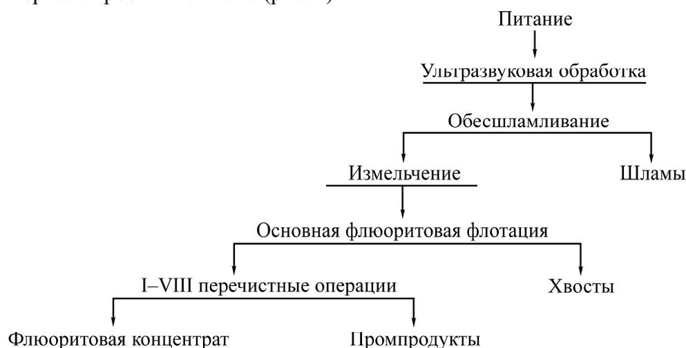
Рис. 2. Схема флотации техногенных хвостов с предварительной десорбцией ультразвуком покрытий первичного цикла обогащения
