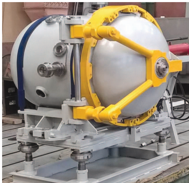
Рис. 2. Установка, предназначенная для проведения рентгенографических исследований взрывных процессов с использованием СИ
