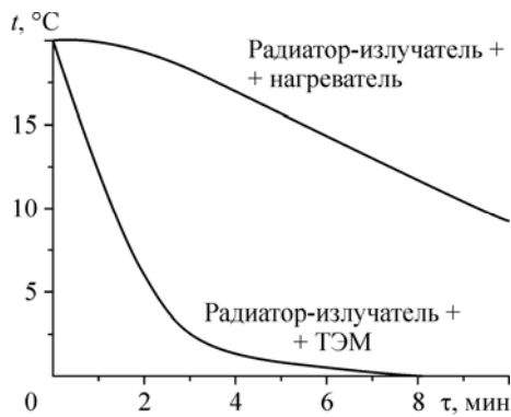
Рис. 14. Зависимость температуры объекта массой 10 г и тепловыделением 10 Вт от времени при его охлаждении от уровня 20 ^\circ\text{C} с максимально возможной скоростью при использовании охладителей с ТЭП и с нагревателем в течении 10 мин.
