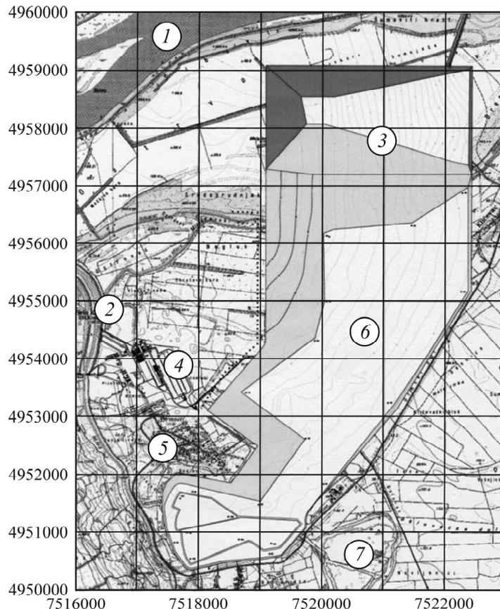
Рис. 1. Окончательная граница эксплуатационного поля угольного карьера “Дрмно”: 1 — р. Дунай; 2 — р. Млава; 3 — угольный карьер “Дрмно”; 4 — теплоэлектростанция “Костолац Б”; 5 — село Дрмно; 6 — внутренние отвалы; 7 — внешние отвалы
